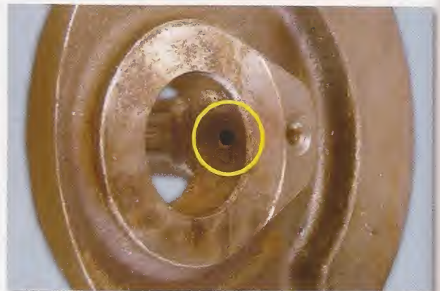
Detalle del orificio de lubricación del cigüeñal
